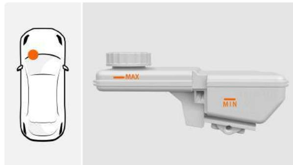
Периодически проверять уровень тормозной жидкости, чтобы убедиться, что он находится между отметками МИН. (MIN) и МАКС. (MAX.)
