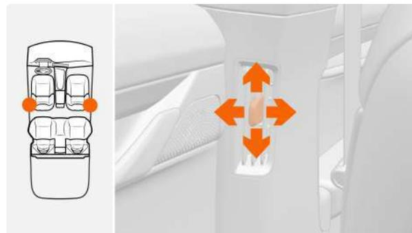
Перемещайте панель управления вверх/вниз/влево/вправо, чтобы настроить направление воздушного потока. Переместите панель управления вниз в максимальное положение, чтобы закрыть отверстия для выхода воздуха.
