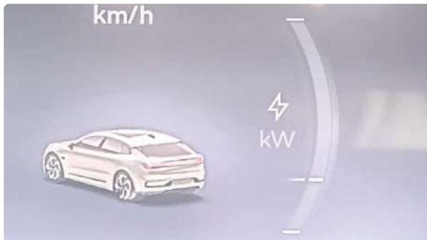
Когда система рекуперативного торможения работает, на комбинации приборов отображается информация о мощности рекуперативного торможения.
