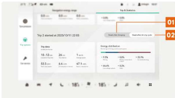
**01** сброс после зарядки: После выбора опции режим поездки 2 будет автоматически сброшен после завершения зарядки.
