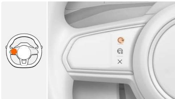
Непродолжительно нажмите кнопку
