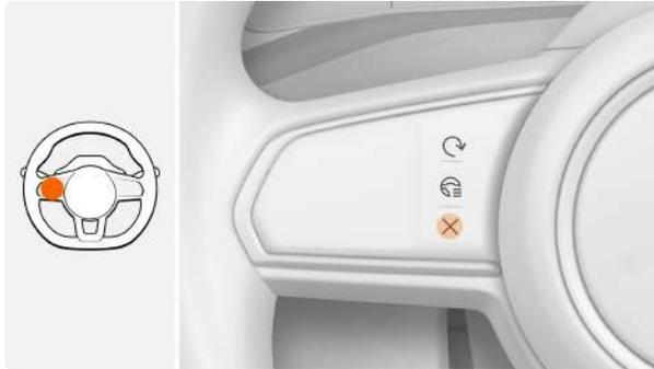
Быстро нажмите кнопку **X** на рулевом колесе, чтобы отключить функцию центрирования полосы движения, при этом на комбинации приборов не отображается крейсерская скорость, а индикатор работы системы центрирования полосы движения становится серым.
