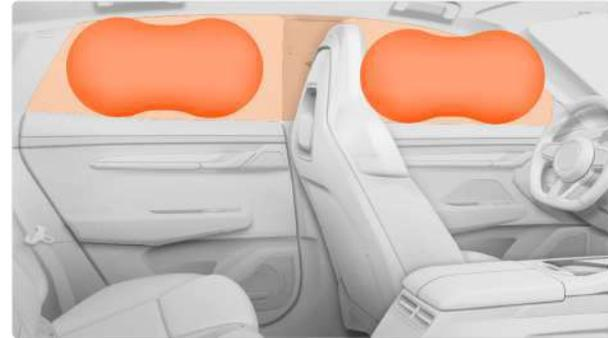
Защитные воздушные завесы для головы установлены по обе стороны обшивки крыши, защищая пассажиров, сидящих на крайних сиденьях. На отделочных панелях нанесена надпись "ПОДУШКА БЕЗОПАСНОСТИ".
