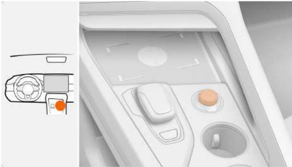
Регулятор громкости на туннельной консоли позволяет выполнять на центральном дисплее следующие действия:
