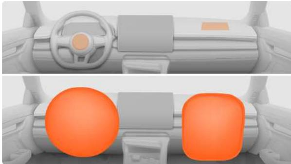
Подушка безопасности водителя установлена в центре рулевого колеса, и на рулевом колесе нанесена надпись "ПОДУШКА БЕЗОПАСНОСТИ". Подушка безопасности со стороны пассажира установлена над перчаточным ящиком, а на приборной панели нанесена надпись "ПОДУШКА БЕЗОПАСНОСТИ".
