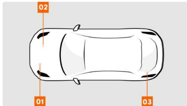
**01** Табличка с указанием местоположения батареи, расположенная на левой стороне облицовочной панели капота двигателя.
