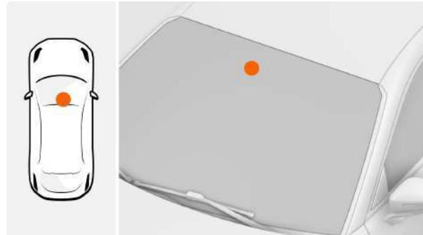
Датчик дождя и освещенности расположен в верхней части ветрового стекла.
