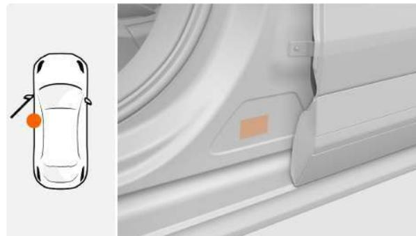
В целях безопасности рекомендуется регулярно проверять давление воздуха в шинах, особенно перед поездками на дальние расстояния. Рекомендуемые значения давления указаны на соответствующей табличке со значениями давления воздуха в шинах (на центральной стойке со стороны водителя).
