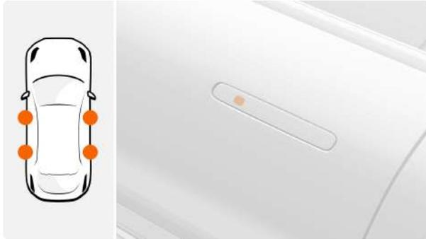
**Разблокировка:** Когда автомобиль заблокирован, подойдите к автомобилю с помощью ключа Bluetooth и прикоснитесь к индукционной области на внешней дверной ручке, чтобы отпереть автомобиль.
