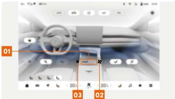
**01** Перетащить ползунок, чтобы отрегулировать объем кондиционируемого воздуха.
