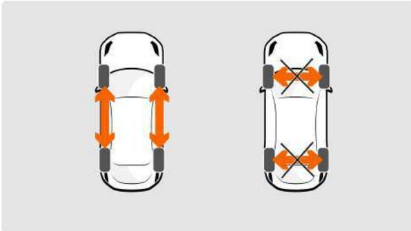
Шины следует поворачивать только спереди и сзади, а не влево и вправо.
