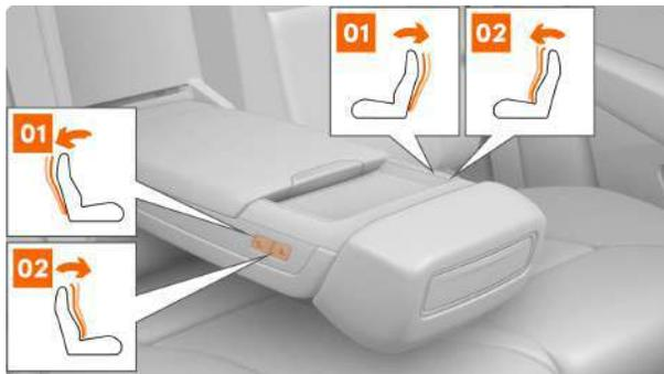
**01** Нажмите кнопку, чтобы отрегулировать угол наклона спинки сиденья назад.
