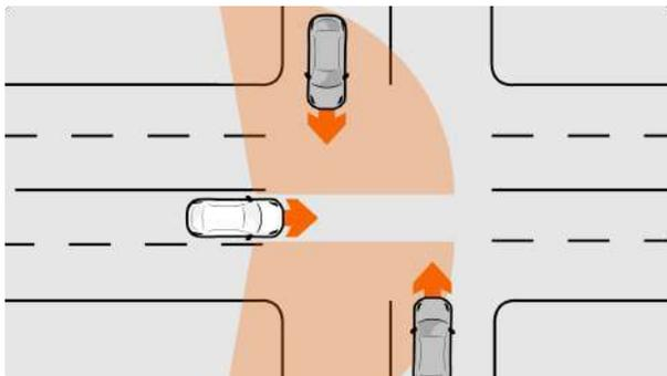
При выезде с парковочного места или пересечении перекрестков с затрудненным обзором, если впереди существует опасность бокового столкновения, система предупреждения о перекрестном движении спереди (FCTA) предупредит водителя о необходимости затормозить или автоматически затормозит, чтобы снизить риск или тяжесть столкновения.
