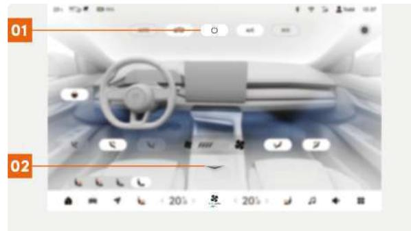
**01** Нажать на кнопку, чтобы включить/выключить переднюю систему кондиционирования воздуха.
