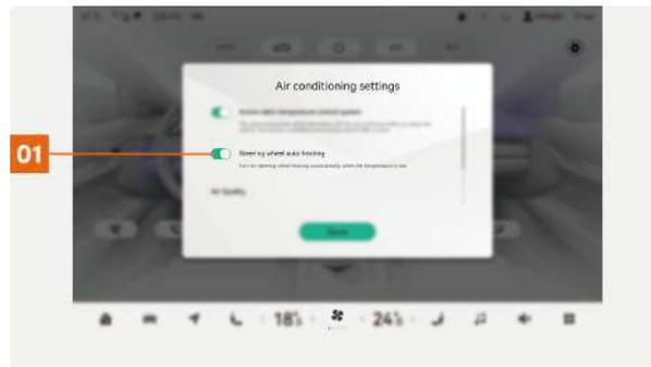
**01** Нажать на кнопку, чтобы включить/выключить автоматический подогрев рулевого колеса.
