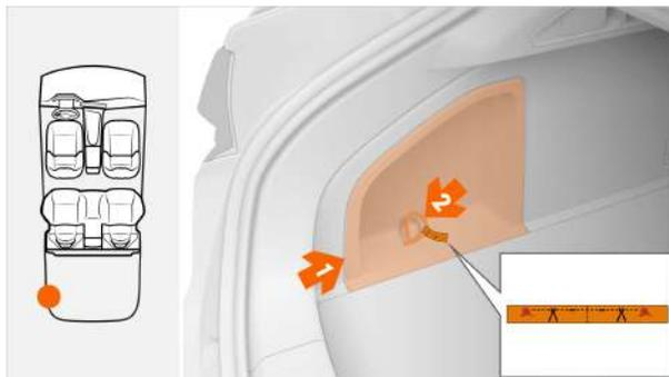
Резервный кабель электропитания для аварийных случаев расположен в панели багажника слева.
