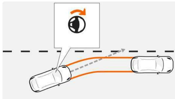
Система предупреждения об отклонении транспортного средства от текущей полосы движения предназначена для случаев, когда водитель не в состоянии управлять автомобилем, которая активирует рулевое управление с целью возвращения автомобиля на полосу движения.
