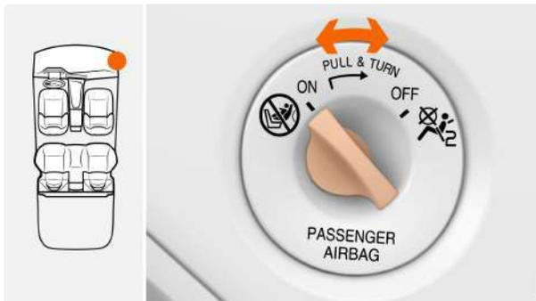
Включите или отключите подушку безопасности со стороны переднего пассажира следующим образом:
