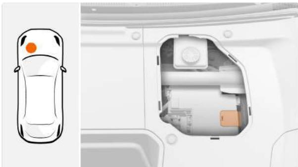
5 Подсоедините красный соединительный кабель к положительной клемме (2) аккумулятора.
