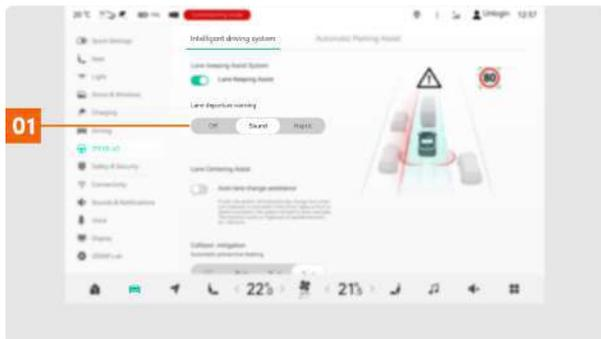
**01** Нажать на кнопку, чтобы включить или выключить систему LDW. Выбрать способ предупреждения о выходе за пределы полосы движения (звуковой сигнал, вибрация).
