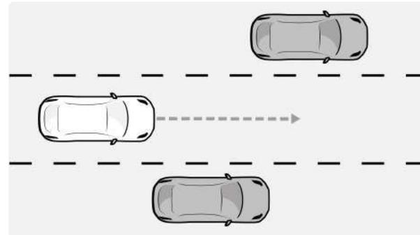
LCC является подфункцией режима активного круиза на полной скорости, может активно регулировать скорость автомобиля на скорости 0-130 км/ч в соответствии с установленной крейсерской скоростью и расстоянием следования, а также может удерживаться в середине полосы движения в соответствии с определенной линией. При запуске LCC всегда держитесь за рулевое колесо и при необходимости немедленно управляйте автомобилем.
