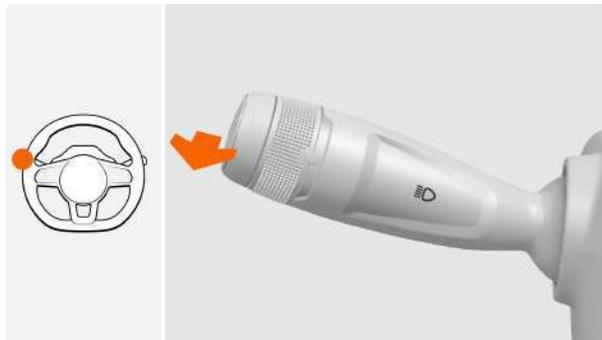
При обгоне впереди идущего автомобиля вы можете переместить рычаг на себя и отпустить, дальний свет мигнет один раз, предупреждая об этом впереди идущий автомобиль.
