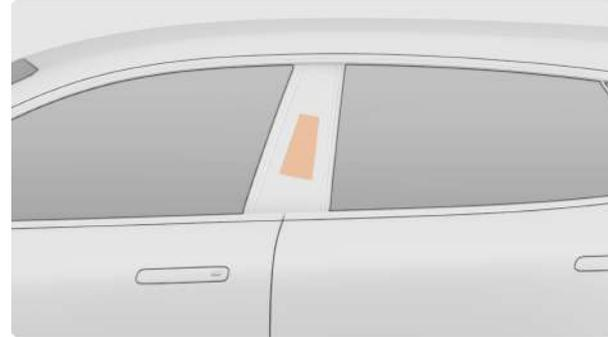
**Разблокировка:** Когда автомобиль заблокирован, прикоснитесь ключом-картой NFC к области ввода ключа, чтобы отпереть все двери.
