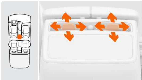
Перемещайте панель управления вверх/вниз/влево/вправо, чтобы настроить направление воздушного потока. Переместите панель управления к середине в максимальное положение, чтобы закрыть отверстия для выхода воздуха.
