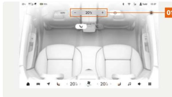
**01** Регулировка температуры кондиционирования воздуха.
