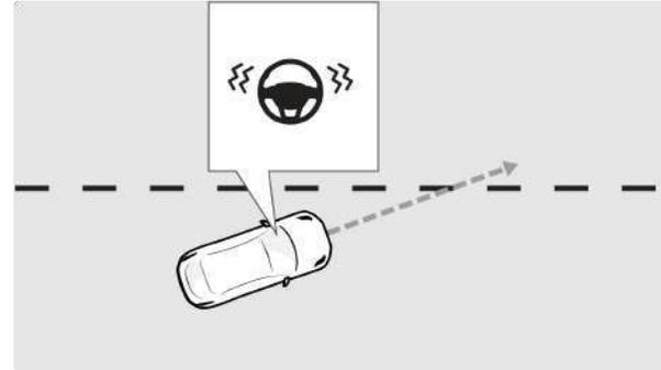
Система предупреждения о выходе транспортного средства за пределы полосы движения предназначена для случаев, когда водитель не в состоянии управлять автомобилем. Предупреждение водителя о выходе транспортного средства за пределы полосы движения (LDW) осуществляется посредством визуальных и звуковых сигналов или вибрации рулевого колеса сигналов.
