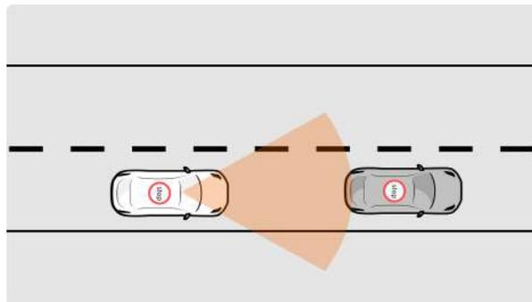
Если целевое транспортное средство затормозит для постепенной остановки, ваше транспортное средство также последует за впереди идущим транспортным средством, чтобы затормозить для постепенной остановки и сохранить безопасную дистанцию.
