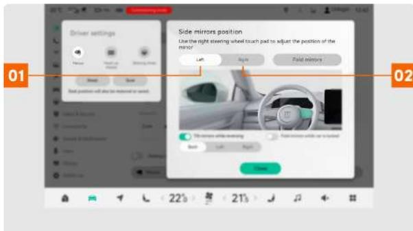
**01** Нажать на кнопку “Слева (left side)” чтобы отрегулировать наружное зеркало заднего вида слева.
