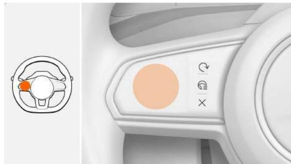
Когда адаптивный круиз-контроль активен, коснитесь сенсорной панели на левой стороне рулевого колеса и откройте интерфейс настройки адаптивного круиз-контроля на комбинации приборов; вы можете установить
