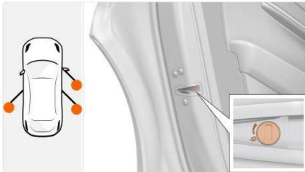
2 Поверните механический ключ на определенный угол, чтобы запереть дверь.
