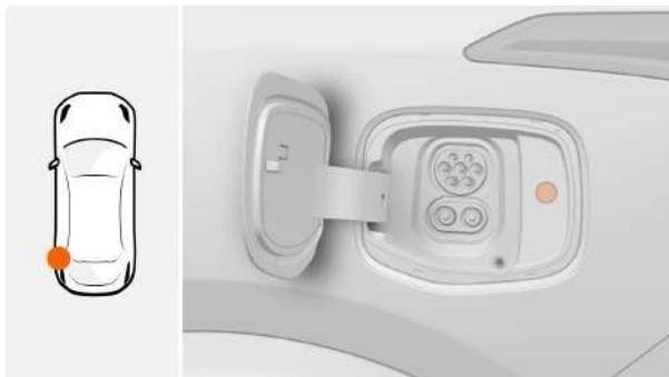
Светодиодный индикатор отображает различные цвета в зависимости от состояния *Зарядка с помощью бортового зарядного оборудования* (р. 284).
