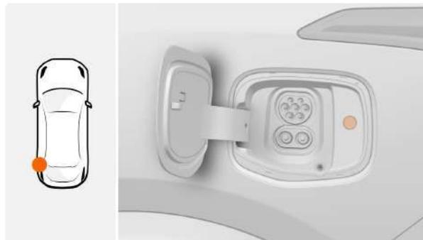
Светодиодный индикатор отображается разными цветами в зависимости от состояния зарядки.
