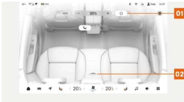
**01** Нажать на кнопку, чтобы включить/выключить заднюю систему кондиционирования воздуха.
