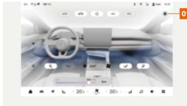
**01** Нажать на значок
