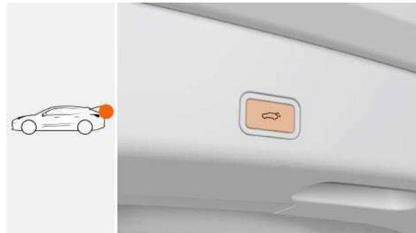
Нажмите кнопку закрытия двери лифта, дверь лифта закроется автоматически.
