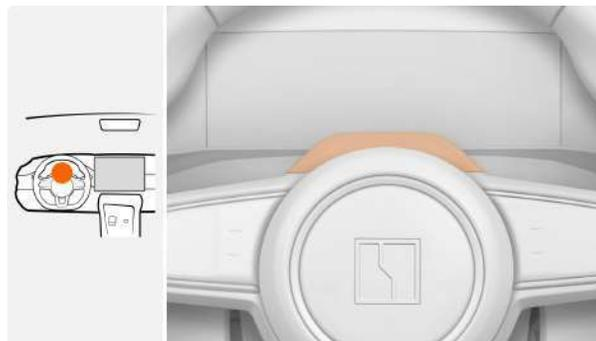
Служба поддержки производительности водителя (DPS) отслеживает работу водителя с помощью камеры системы видеонаблюдения. Если будет установлено, что водитель ведет машину уставшим или отвлеченным, система подаст звуковые или визуальные сигналы, предупреждающие водителя о необходимости обеспечения безопасности вождения.
