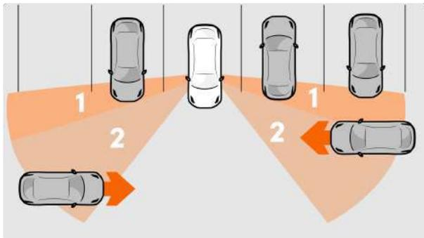
**01** Слепая зона (обзор датчиков затруднен).
