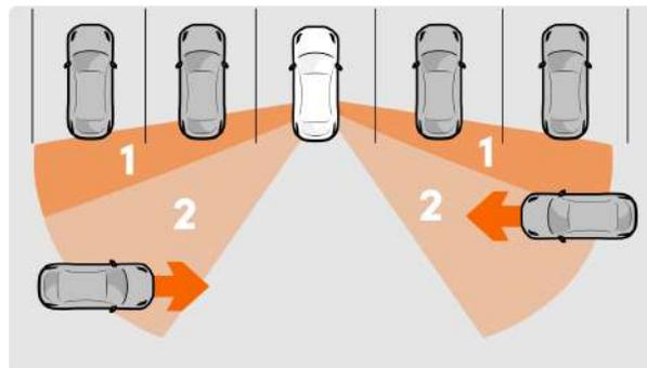
**01** Слепая зона (обзор датчика ограничен).
