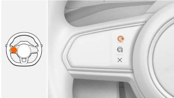
Нажмите и отпустите кнопку
