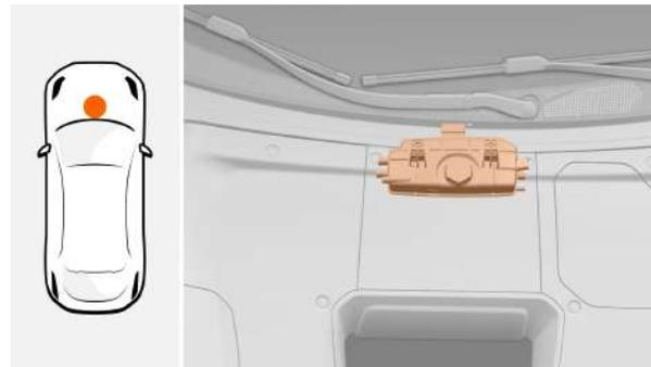
Расширительный бачок системы охлаждения находится в передней части багажника
