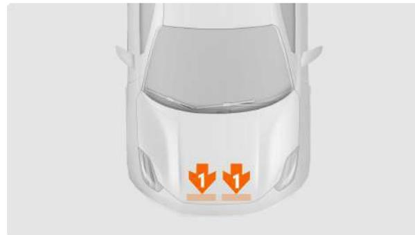
2 Придавить капот обеими руками, как показано на рисунке, до фиксации в замке, чтобы полностью закрыть капот.
