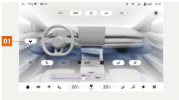
**01** Долговременно нажать на значок
