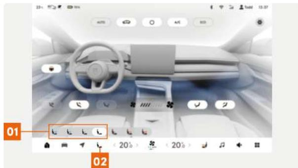
**01** Сдвиньте функциональное меню водительского сиденья, чтобы выбрать различные уровни вентиляции для водительского сиденья или отключить функцию вентиляции сиденья (ВЫКЛ.-1-2-3).
