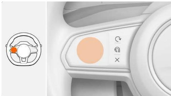
Когда активна система управления центрированием полосы движения, коснитесь сенсорной панели на левой стороне рулевого колеса и откройте интерфейс настройки системы
