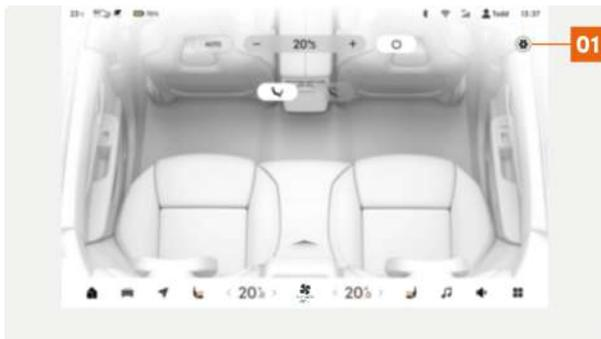
**01** Нажать на значок
